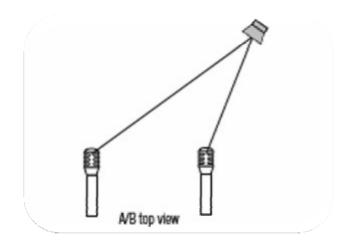
最受欢迎的专业话筒技术之一是立体扩音。使用两个或多个话筒可以营造出立体声效果,增加乐器或整体录音的深度感和空间感。营造立体声有多种不同方法。最常用的三种方法是两个话筒隔开摆放(A/B)、两个话筒重合或接近重合摆放(X-Y 配置)、以及中-边摆放(M-S)技术。
