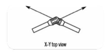
X-Y 技术使用同型号、同厂家的两个心形话筒,两个话筒振膜要么尽量靠近(重合方式)、要么相距 12 英寸(接近重合方式),且呈 90-135 度角摆放,具体取决于声源大小及声音要求。将两个话筒的中心对准声源,且按左右摆放。由于话筒间距较小,声音几乎同时抵达话筒,这样就减少(接近重合方式)或消除(重合方式)了 A/B 技术可能出现的相位问题。
